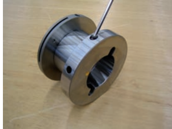
Hydro-Dehndorn-Flansch auf Spindel montiert!!!!
