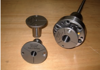
Hydro-Dehndorn-Flansch auf Spindel montiert!!!!
